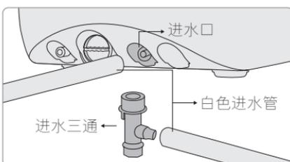
② 用白色进水管一端连接进水口，另一端与进水三通相连。
