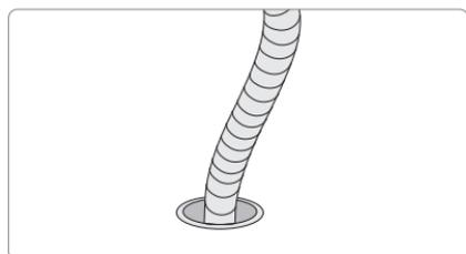
② 排水管插入地漏内一定深度（建议大于5cm）防止排水过程中水管脱落。
