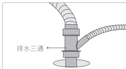
③ 必要时，可以使用排水三通，将2台洗衣机排水管接入一个地漏。
