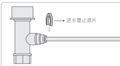
③ 将进水管止退片插到进水三通卡圈上及机器进水口。
