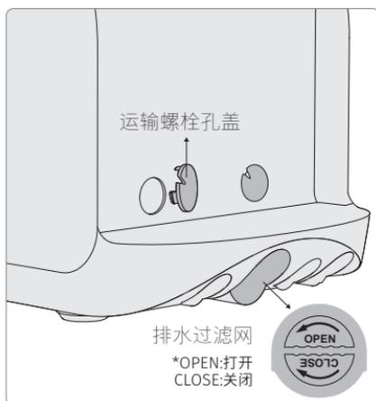
① 将2个运输螺栓逆时针旋转，并从孔位拉出。请保管好运输螺栓，以备再次搬运洗衣机时使用。
